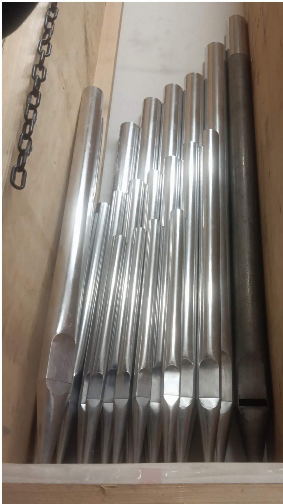
Zrestaurovaná píšťala a rekonstrukce zbytku rejstříku Octavbass 4'
