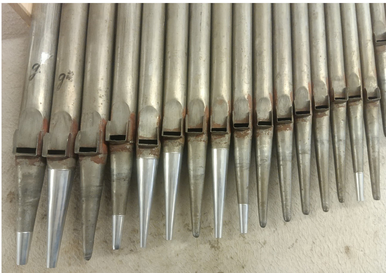
Kovové píšťaly hlavního stroje, Salicional – výspraва zborcených nohou
