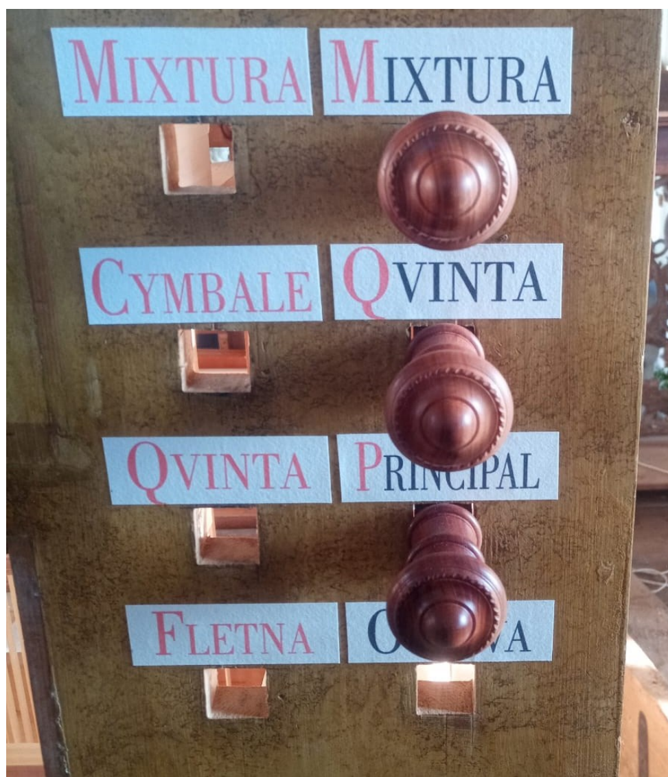
Rekonstrukce manubria a rejstříkových štítků
