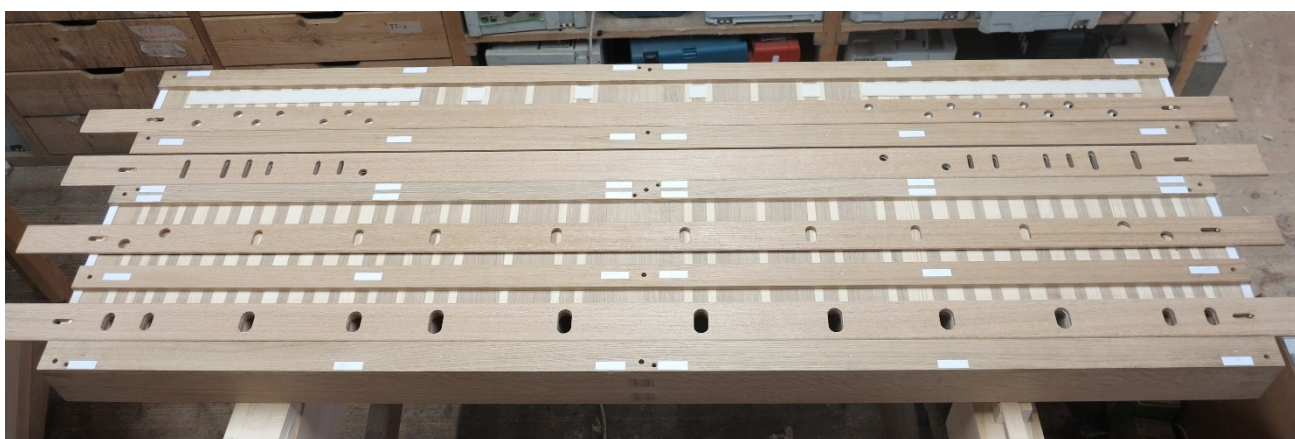
Rekonstrukce pedálové vzdušnice – horní pohled
