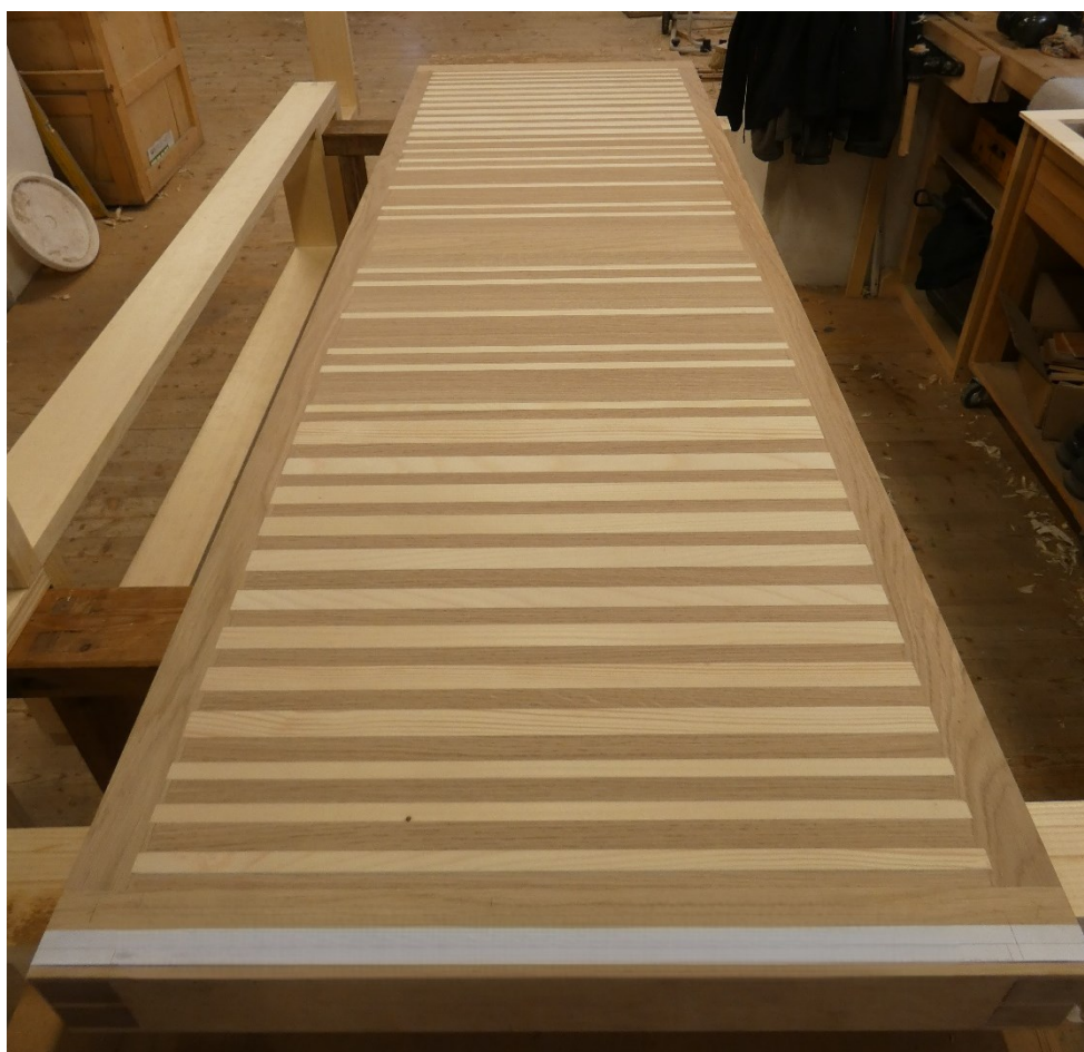
Rekonstrukce pedálové vzdušnice – v průběhu prací
