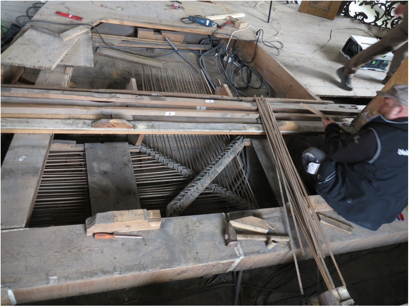
Demontáž rejstříkové traktury
