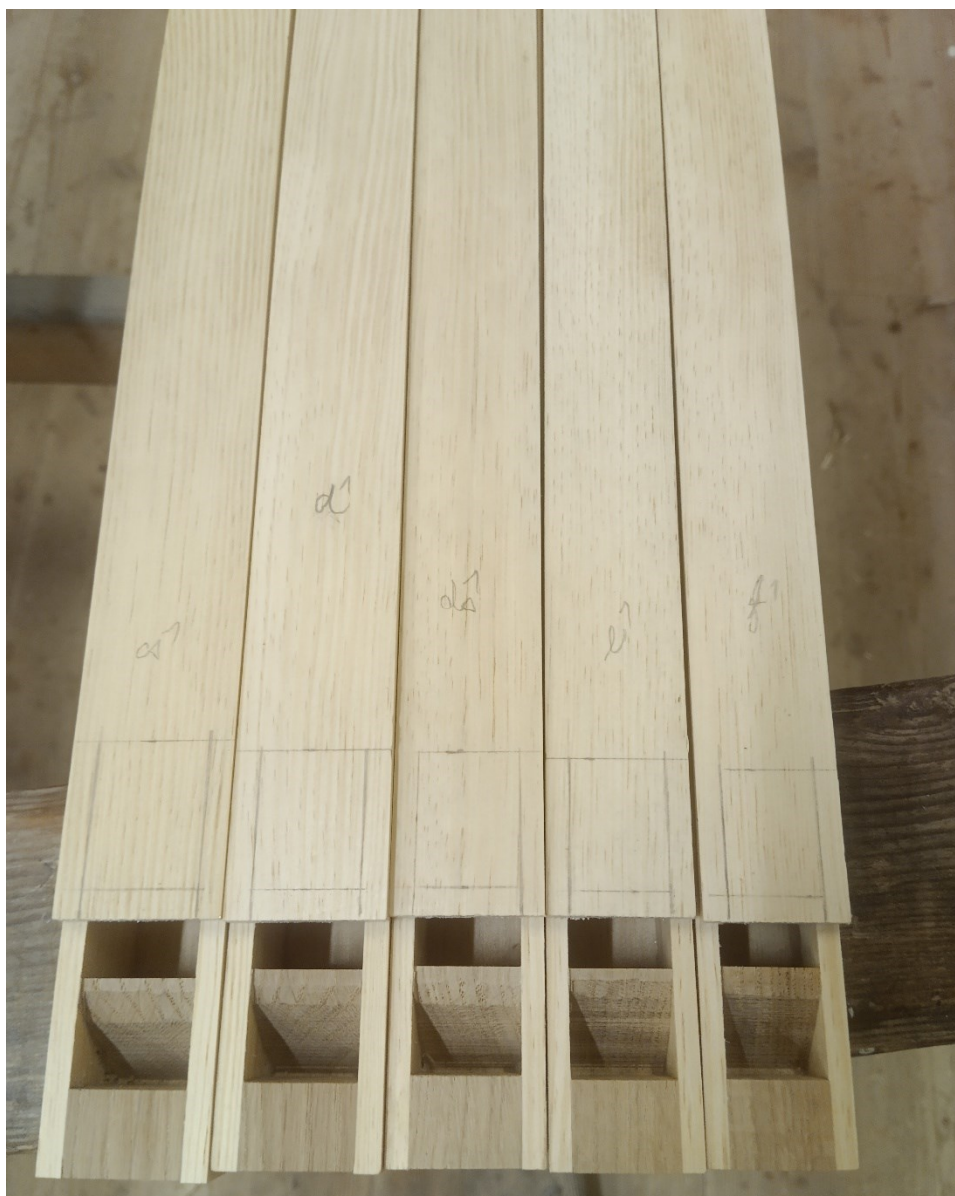
Rekonstrukce dřevěných píšťal manuálu – Fletna 8', píšťaly cs1-f1
