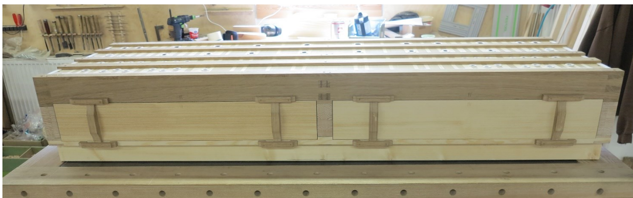
Rekonstrukce pedálové vzdušnice – boční pohled
