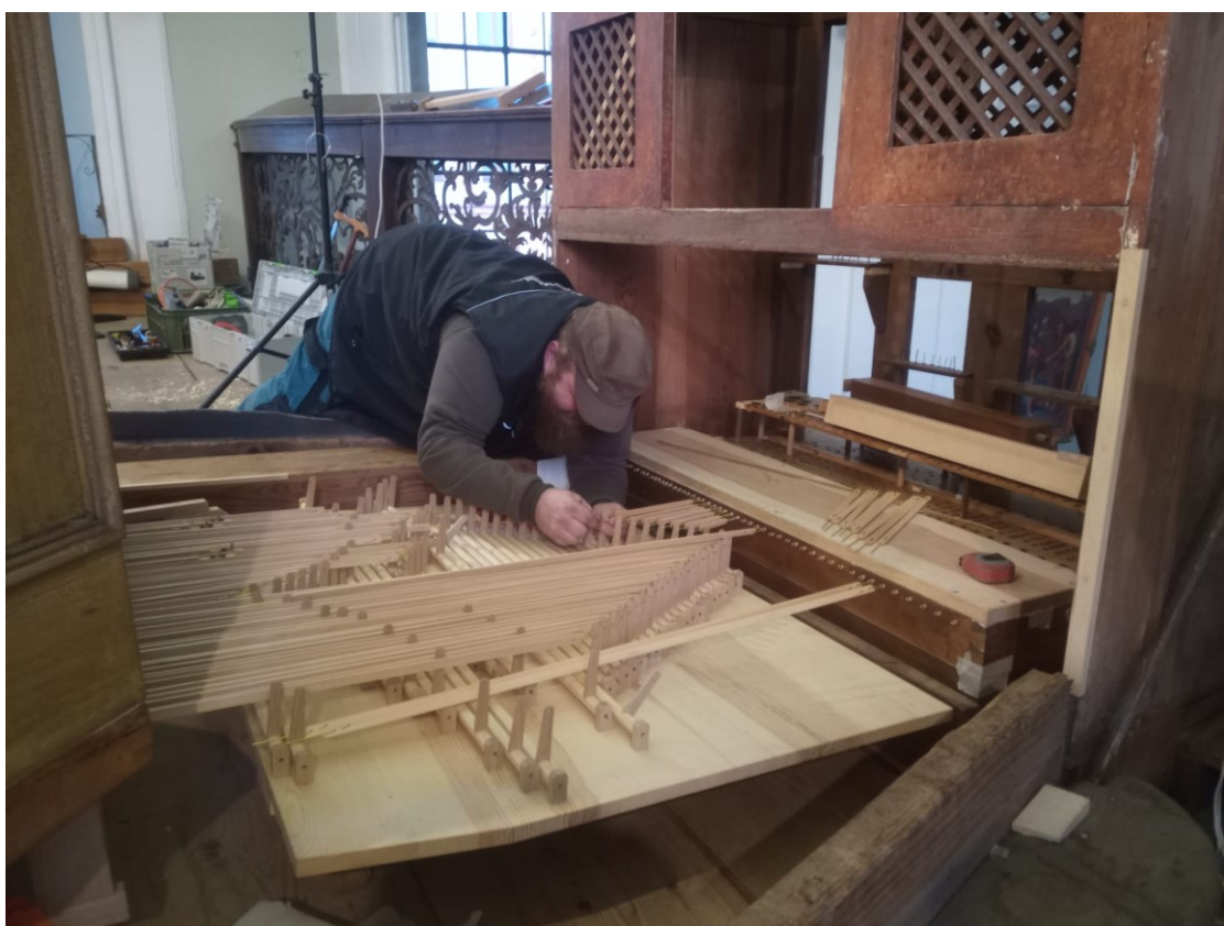
Montáž zadního positivu – zapojování tónové traktury
