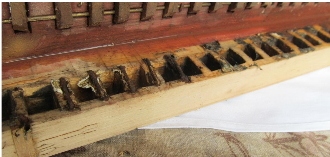
Vzdušnice pozitivu – detaily poškození na pulpetové desce
