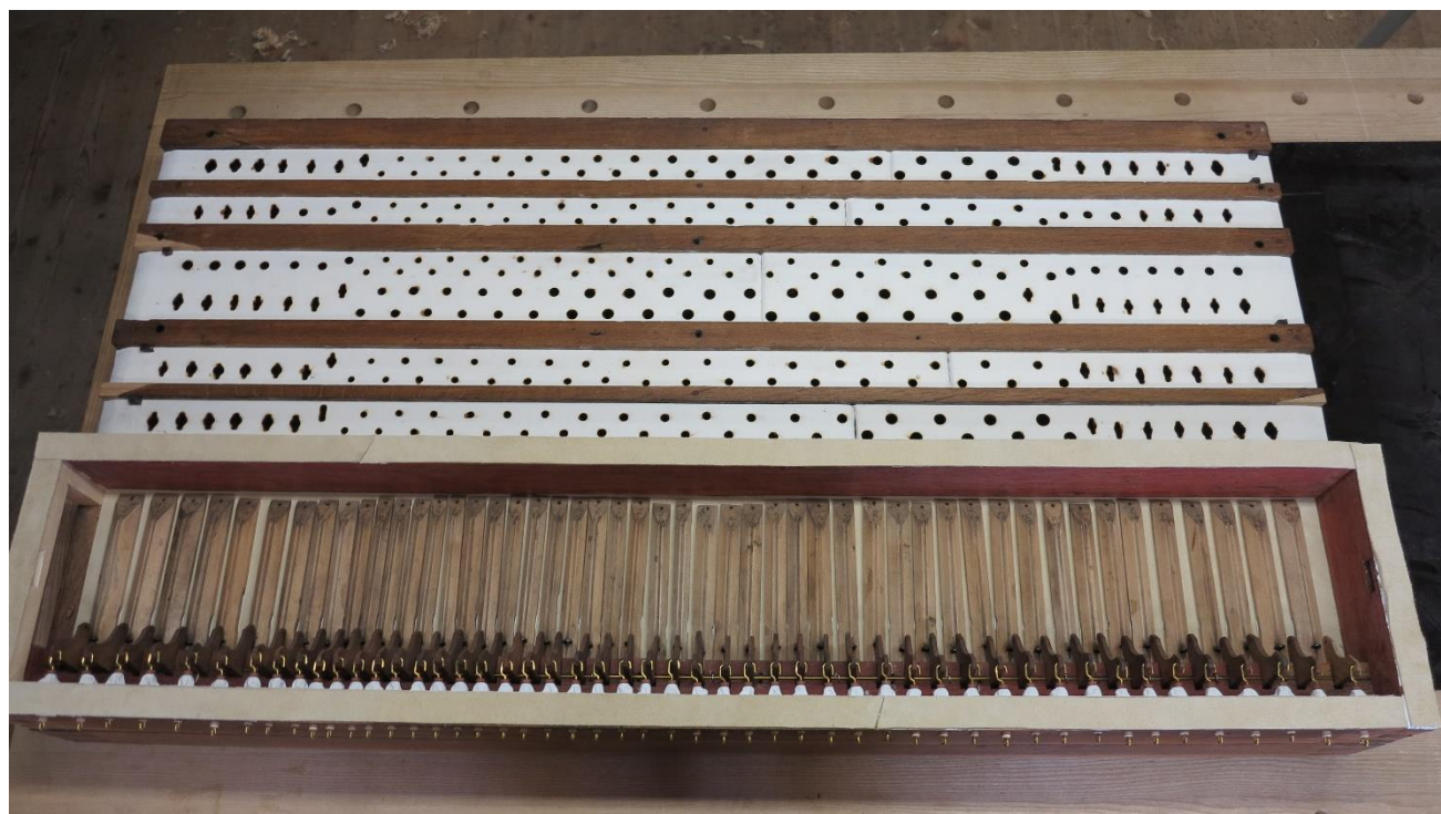
Vzdušnice pozitivu – po dokončení
