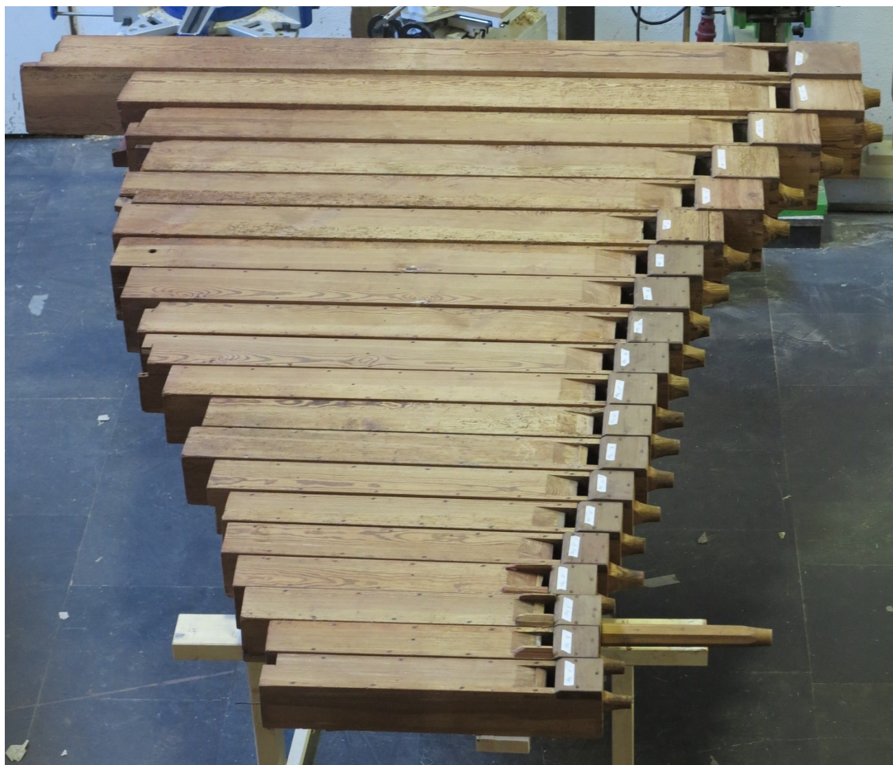
Octavbass 8' - stav po chemickém a mechanickém snímání mnohočetných barevných vrstev, po petrifikaci v roztoku Solakrylu BMX
