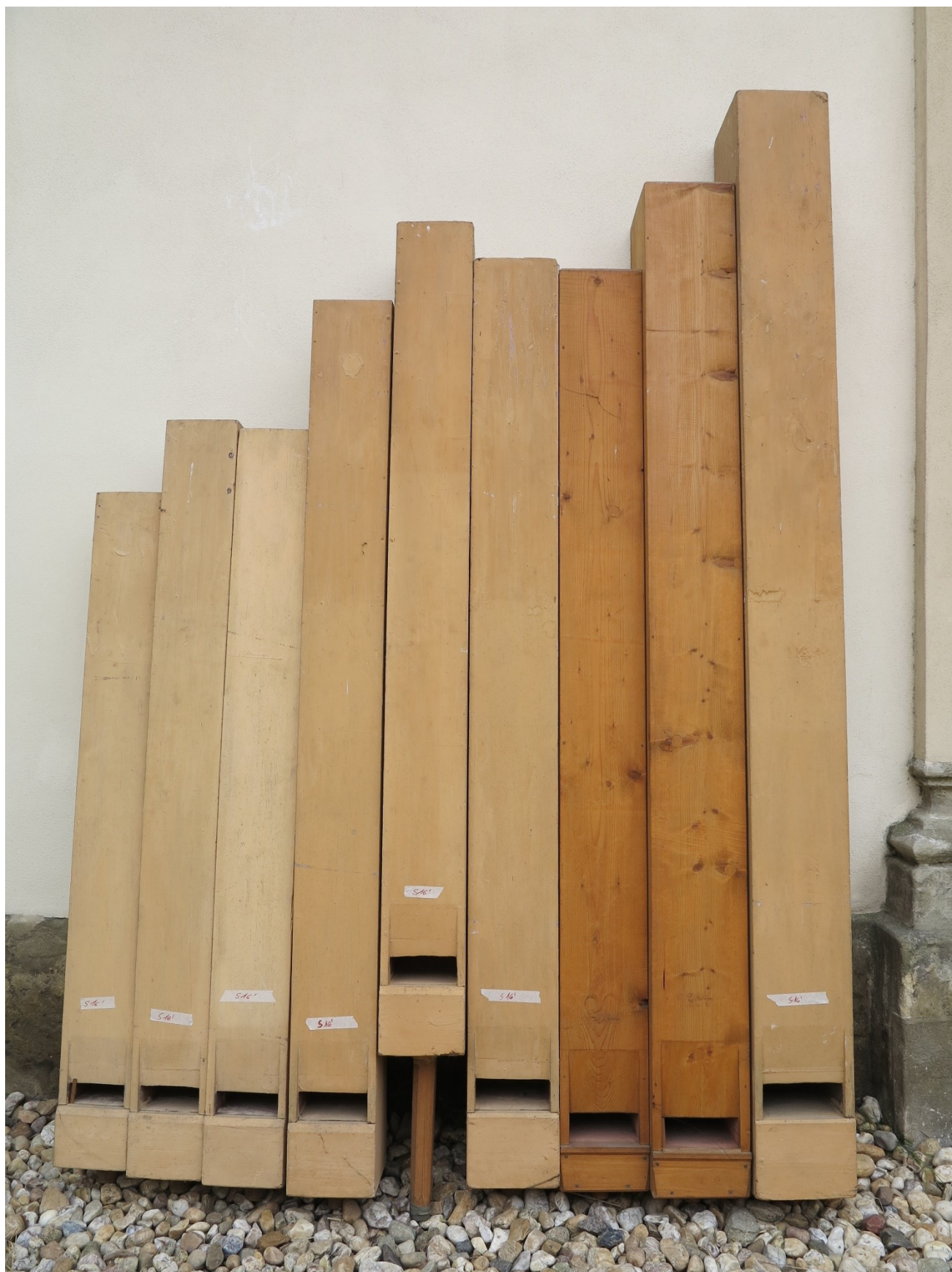
Subbass 16' - basová část – stav po demontáži
